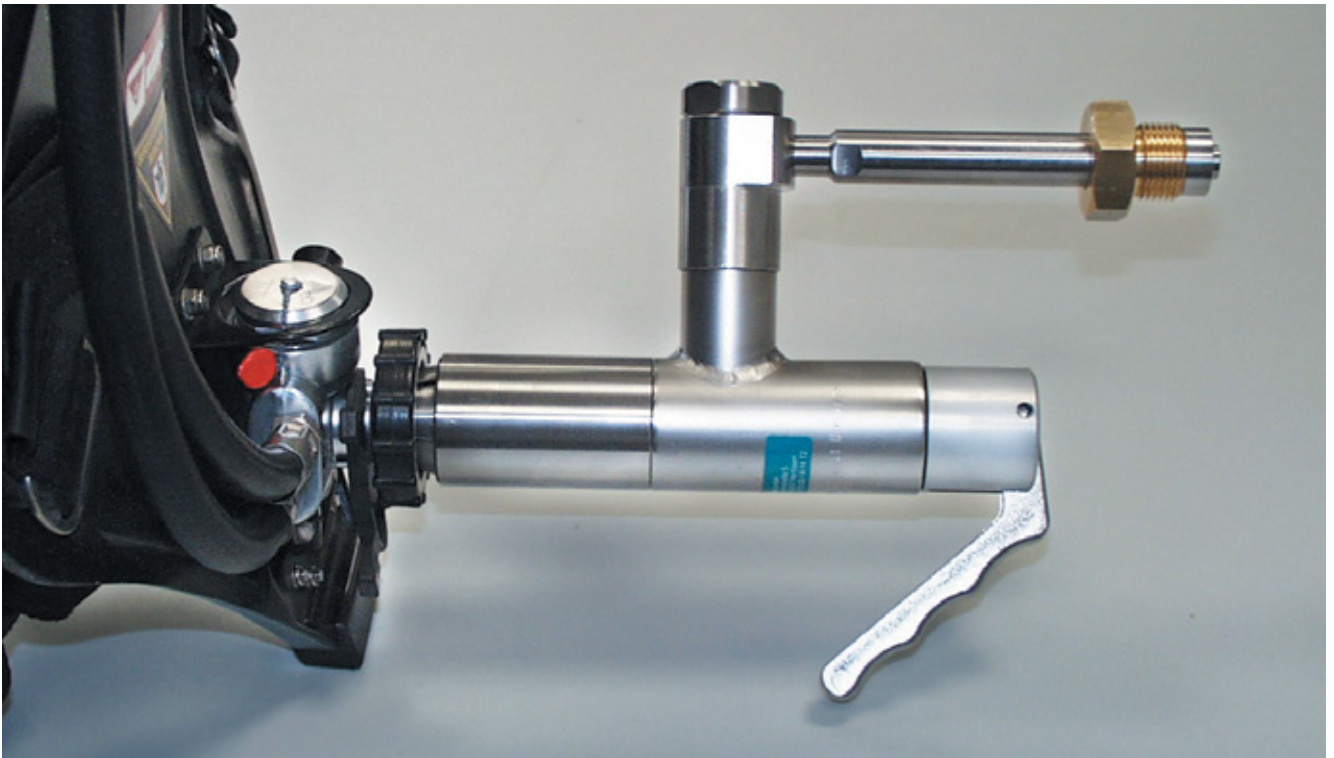
Prüfen von Atemschutzgeräten mit dem TW156
