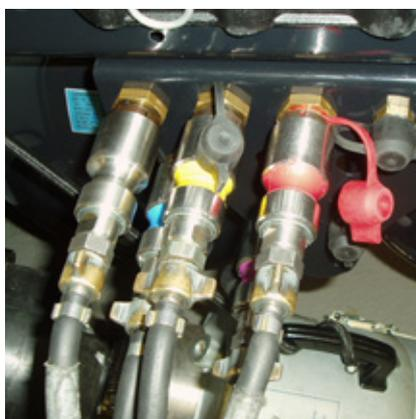
TW110 | Zum Füllen und Evakuieren von Kfz-Klimaanlagen während der Produktion
